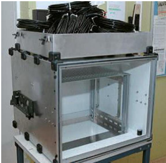
I denna låda, upphängd i en yttre låda installeras exempelvis en router (Foto Teleanalys)
