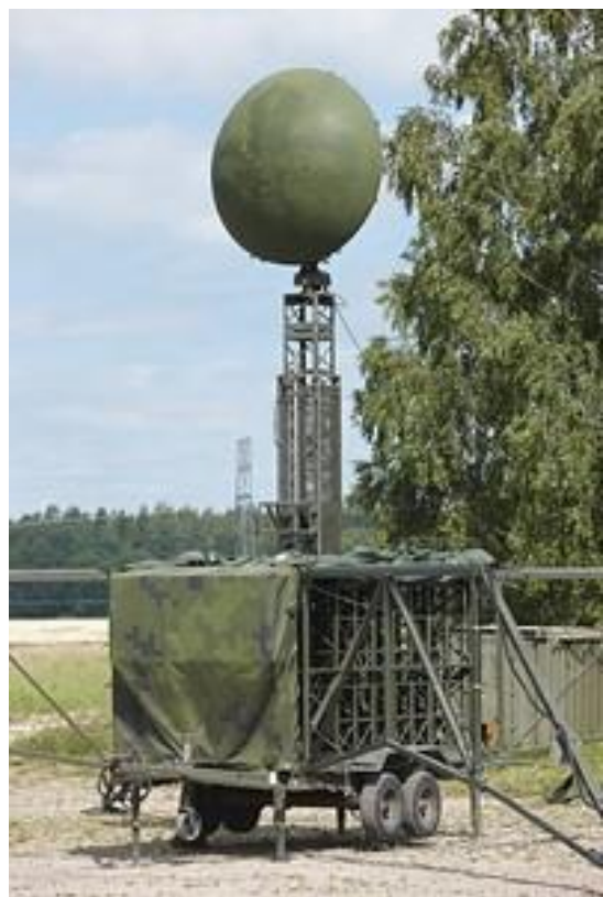
Mast till Transportabel radiolänk (Foto processmekanik)
